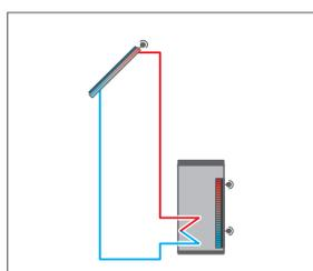
Système de chauffage solaire standard
