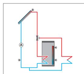
Système de chauffage solaire standard avec évacuation de l'excès de chaleur
