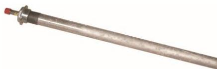
Avec ce modèle d'anode simple test, le contrôle se fait en dévissant le bouchon rouge. En cas d'écoulement d'eau l'anode est à remplacer
