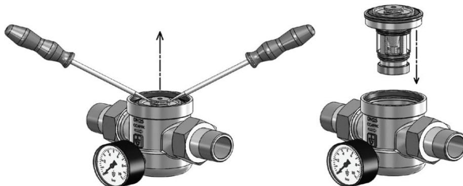
Mécanisme démontable pour nettoyage ou remplacement
