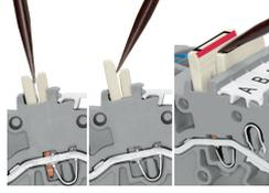
Les repères rouges du pont intercalable sont à diriger vers l'intérieur. Placer le pont intercalable et le pousser jusqu'en butée.
