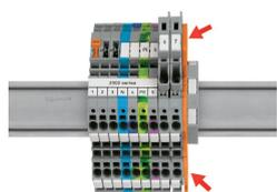
L'utilisation d'une plaque d'extrémité pour borne à fusible est nécessaire (par ex. 2002-1092, orange) en fin de montage ou s'il n'y a pas de borne à fusible adjacente.
