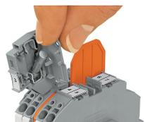
Une plaque d'extrémité pour borne à fusible (ici orange, 2002-1092) sert de protection supplémentaire contre l'ouverture du porte-fusible. Le remplacement de fusible ne peut se faire que lorsque le porte-fusible a été déconnecté du circuit.
