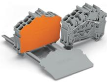
Dans le cas du passage d'une borne pour 3 conducteurs à une borne pour 4 conducteurs (forme coudée), et vice versa, il faut monter une plaque d'extrémité.
