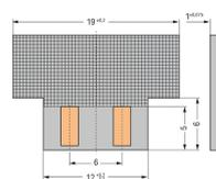
Dimensions pour circuits imprimés à pose automatique
