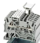
Porte-étiquettes de groupe TOPJOB®S (2009-193), ici avec bandes de marquage, utilisable pour toutes les bornes sur rail TOPJOB®S des séries 2000 à 2016. Ne pas placer par-dessus une plaque d'extrémité !
