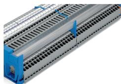
Le support de barre collectrice fin (épaisseur 1,5 mm) a une fonction de soutien supplémentaire de la barre collectrice en cas de longs alignements de bornes (chaque 200 mm).
