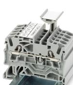
Porte-étiquettes de groupe TOPJOB®S (2009-193), ici avec bandes de marquage, utilisable pour toutes les bornes sur rail TOPJOB®S des séries 2000 à 2016. Ne pas placer par-dessus une plaque d'extrémité !
