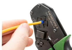
Presser les deux poignées jusqu'à ce que le cran de verrouillage, qui retient l'embout, se débloque.
