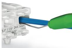
Démontage d'un connecteur enfiché : insérer l'outil de desserrage en dessous du conducteur et retirer le conducteur conjointement avec l'outil de desserrage.
