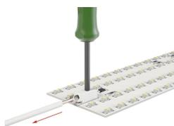
Connexion des conducteurs souples et déconnexion des conducteurs – avec légère pression sur le poussoir.
