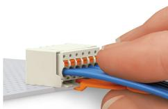
Introduire l'outil de déverrouillage jusqu'en butée. L'outil de déverrouillage ouvre la languette de verrouillage et la libère.
