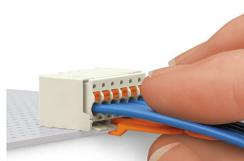
Introduire l'outil de déverrouillage jusqu'en butée. L'outil de déverrouillage ouvre la languette de verrouillage et la libère.
