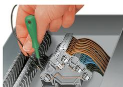
En raison de la dimension de sa lame selon DIN 5264, l'outil de manipulation ci-dessus est spécialement adapté pour la manipulation de bornes de capteurs et d'actionneurs à câblage frontal de la série 280.
