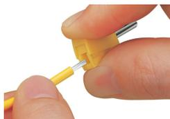
Raccordement du conducteur : presser le boîtier sur l'ouverture rectangulaire et introduire le conducteur.
