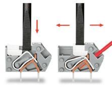
Connexion du conducteur : Sectionnement direct du ressort à l'aide d'un outil de manipulation ou déplacer le curseur d'actionnement vers l'ouverture d'introduction du conducteur. Introduire le conducteur dénudé jusqu'à la butée et remettre le curseur d'actionnement dans sa position de départ (l'actionnement est aussi possible sans outil, à l'aide de l'ongle).
