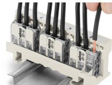
Démontage du conducteur de l'adaptateur de fixation
