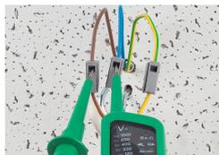
Tester par un point de test séparé.
