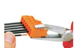
Raccordement du conducteur à l'aide de l'outil de manipulation
