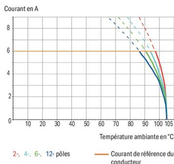
Borne pour circuits imprimés série 233 avec introduction du conducteur vers la platine de 30 °
