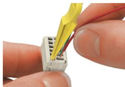
Raccordement des conducteurs avec outil de manipulation 233-331. Manipulation dans le même axe que le conducteur
