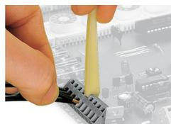
Raccordement des conducteurs, avec outil de manipulation
