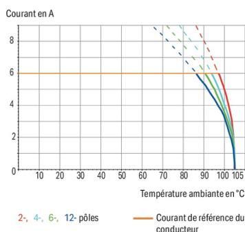
Borne pour circuits imprimés série 233 pas de 2.54 mm
