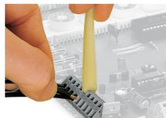
Raccordement des conducteurs, avec outil de manipulation
