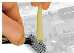
Raccordement des conducteurs, avec outil de manipulation
