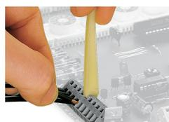
Raccordement des conducteurs, avec outil de manipulation
