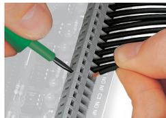
Raccordement des conducteurs avec un outil de manipulation (largeur de lame 3,5 mm)
