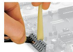
Raccordement des conducteurs, avec outil de manipulation
