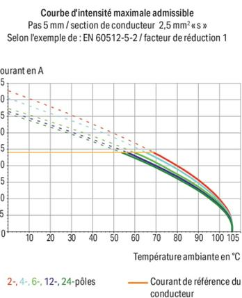
Borne pour circuits imprimés série 236 avec introduction du conducteur vers la platine de 45 °
