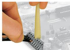
Raccordement des conducteurs, avec outil de manipulation
