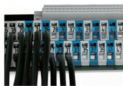
Les barrettes à bornes agencées les unes derrière les autres permettent une économie de place – pour un agencement en décalage d'un demi pas, elles facilitent le câblage ultérieur de la rangée avant.
