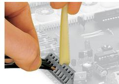
Raccordement des conducteurs, avec outil de manipulation
