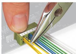
Raccordement des conducteurs – Introduire les conducteurs à fond avec une pince – au choix, directement sur la platine.
