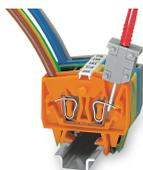
Connexion CAGE CLAMP® sur rail conducteur - courant nominal max. 6 A ; La connexion CAGE CLAMP® serre des contacts de test individuels. La tension de test maximale est 400 V.
