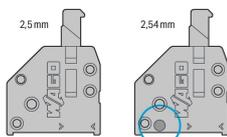
Une cavité sur la face arrière de la borne sert de distinction des pas.
