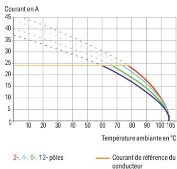
Borne pour circuits imprimés série 254 pas de 7.5 mm
