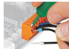
Connexion/Déconnexion des conducteurs – Conducteurs avec embouts d'extrémité
