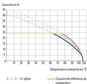
Borne pour circuits imprimés série 256 pas de 7.5 mm
