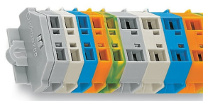
Barrettes à bornes avec bride de fixation, pour vis et autres fixations, diamètre de trou de fixation Ø 3,2 mm (avec pied de montage réf. 209-123 pour rail DIN TS 35)
