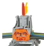
Les barrettes de modules de fiche de contrôle peuvent être encliquetées facilement, même sur les bornes déjà câblées. Étant donné que le contact s'effectue par contact direct sur le ressort CAGE CLAMP® en acier, le courant nominal est limité à 0,5 A.
