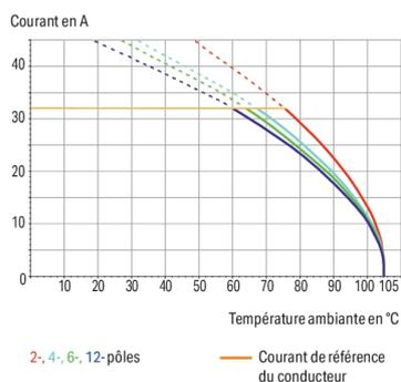
Borne pour circuits imprimés série 2604 avec introduction du conducteur vers la platine de 0°
