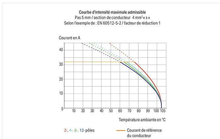
Borne pour circuits imprimés série 2604 avec introduction du conducteur vers la platine de 0°
