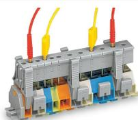
Les barrettes de modules de fiche de contrôle peuvent être encliquetées facilement, même sur les bornes déjà câblées. Étant donné que le contact s'effectue par contact direct sur le ressort CAGE CLAMP® en acier, le courant nominal est limité à 0,5 A.
