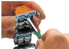
Barrettes à bornes ; avec brides de fixation, Vissage de l'adaptateur de montage (209-123) La distance entre les adaptateurs de montage sous la barrette à bornes doit être env. de 25 à 30 mm)
