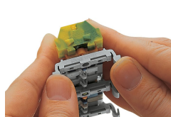
Barrette à bornes avec pieds de fixation à encliqueter Encliquetage du pied de montage (209-120) La distance entre les adaptateurs de montage sous la barrette à bornes doit être env. de 25 à 30 mm)
