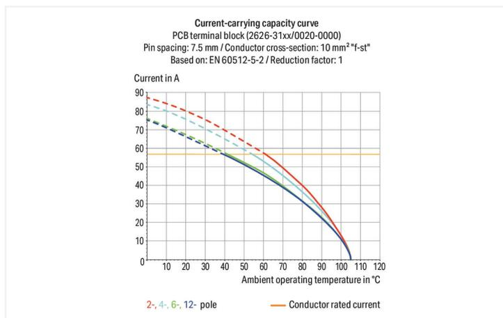
Borne pour circuits imprimés série 2626 avec introduction du conducteur vers la platine de 90 °
