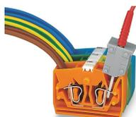
Contact direct, sur le ressort de la connexion CAGE CLAMP®, le courant nominal est limité à 0,5 A et la tension de test maximale à 48 V ; les broches de test ne sont pas protégées contre les contacts.
