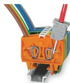
Contact direct, sur le ressort de la connexion CAGE CLAMP®, le courant nominal est limité à 0,5 A et la tension de test maximale à 48 V ; les broches de test ne sont pas protégées contre les contacts.
