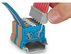
Contact direct, sur le ressort de la connexion CAGE CLAMP®, le courant nominal est limité à 0,5 A et la tension de test maximale à 48 V ; les broches de test ne sont pas protégées contre les contacts.
